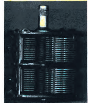
Μεταβλητός πυκνωτής. Εικόνα 1.5-48.
