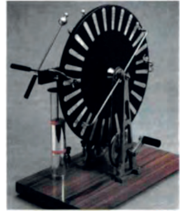
Μηχανή Wimshurst. Εικόνα 1.5-51.
